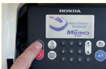
Een duidelijk en gebruiksvriendelijk bedieningspaneel waarmee u de functies van Miimo kunt wijzigen en een beveiligingscode kunt instellen
