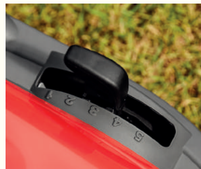
Hendel voor hoogteverstelling van het maaidek
